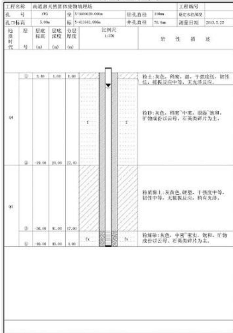
图 3.1-8 园区典型钻孔柱状图
