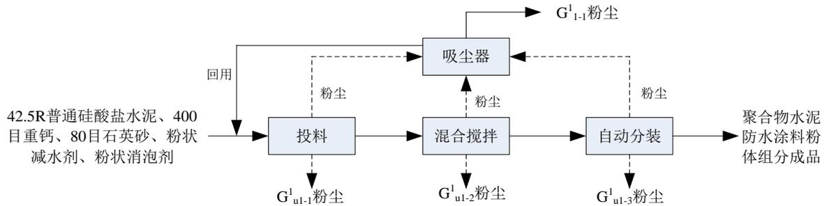
图 4.3-1 聚合物水泥防水涂料中粉体组分工艺流程及产污环节图
