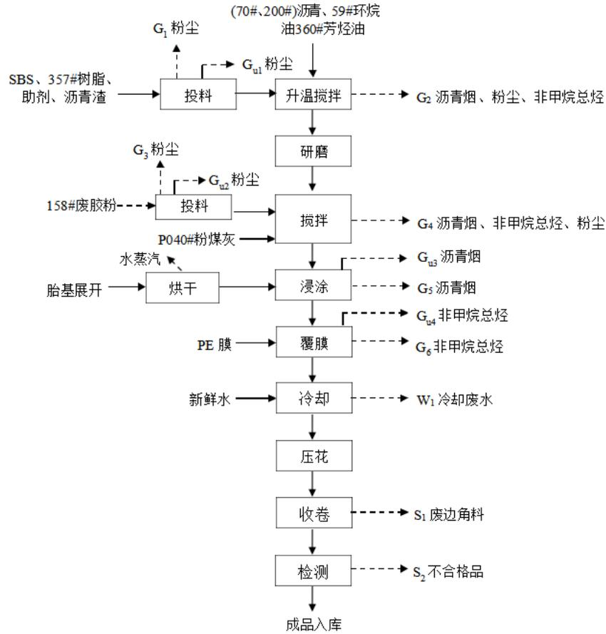
图 4.3-12 改性沥青防水卷材+建筑防水卷材工艺流程及产污环节图
