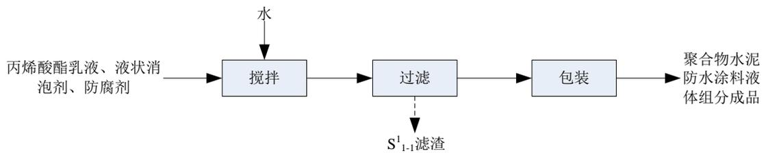
图 4.3-2 聚合物水泥防水涂料中液体组分工艺流程及产污环节图
