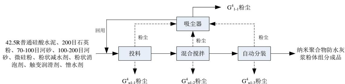
图 4.3-10 纳米聚合物防水灰浆粉体组分工艺流程及产污环节图
