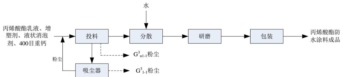
图 4.3-3 丙烯酸酯防水涂料工艺流程及产污环节图
