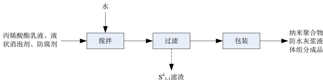
图 4.3-11 纳米聚合物防水灰浆液体组分工艺流程及产污环节图
