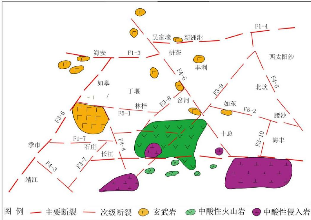
图 3.1-1 如东及周边地区断裂构造图
