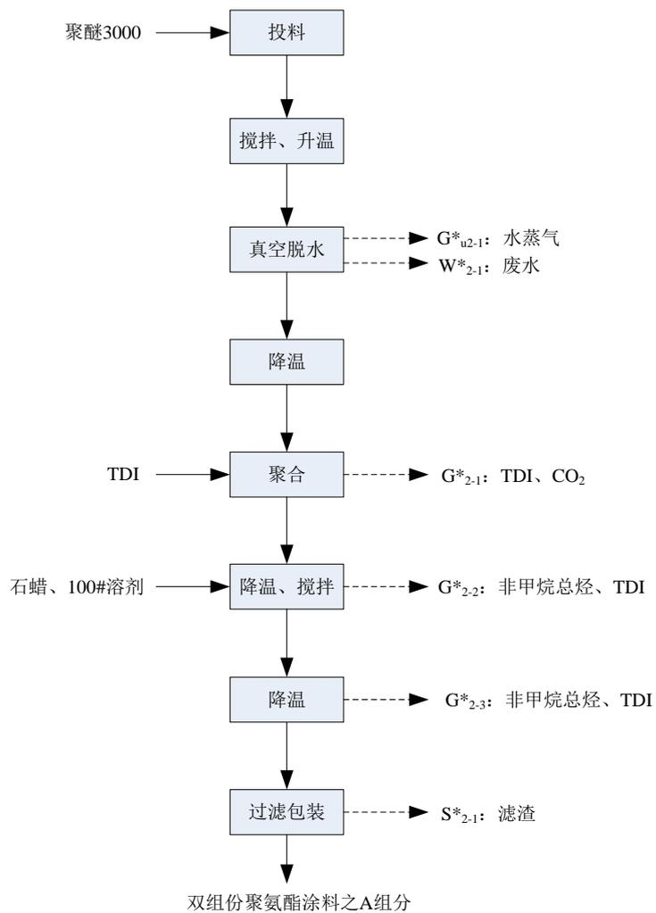
图 4.3-5 双组份聚氨酯防水涂料之 A 组分工艺流程及产污环节图
