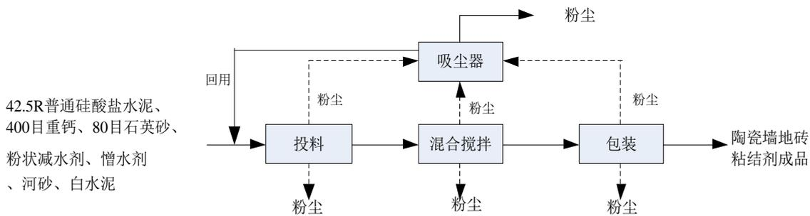
图 4.3-8 陶瓷墙地砖粘结剂工艺流程及产污环节图
