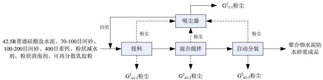
图 4.3-7 聚合物水泥防水砂浆工艺流程及产污环节图
