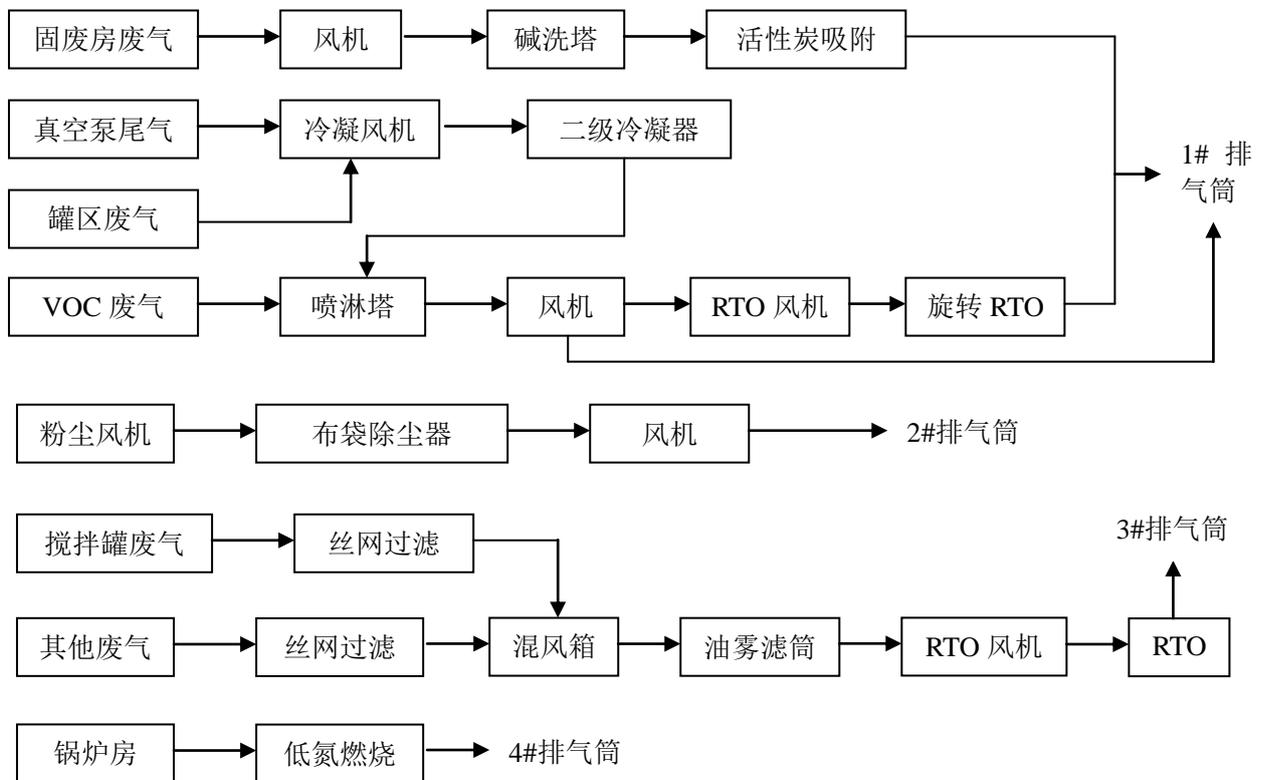
图 4.3-14 全厂废气治理工艺流程图
