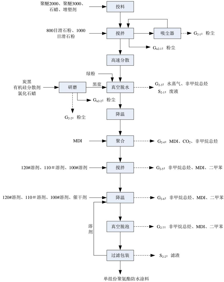
图 4.3-4 单组份聚氨酯防水涂料工艺流程及产污环节图
