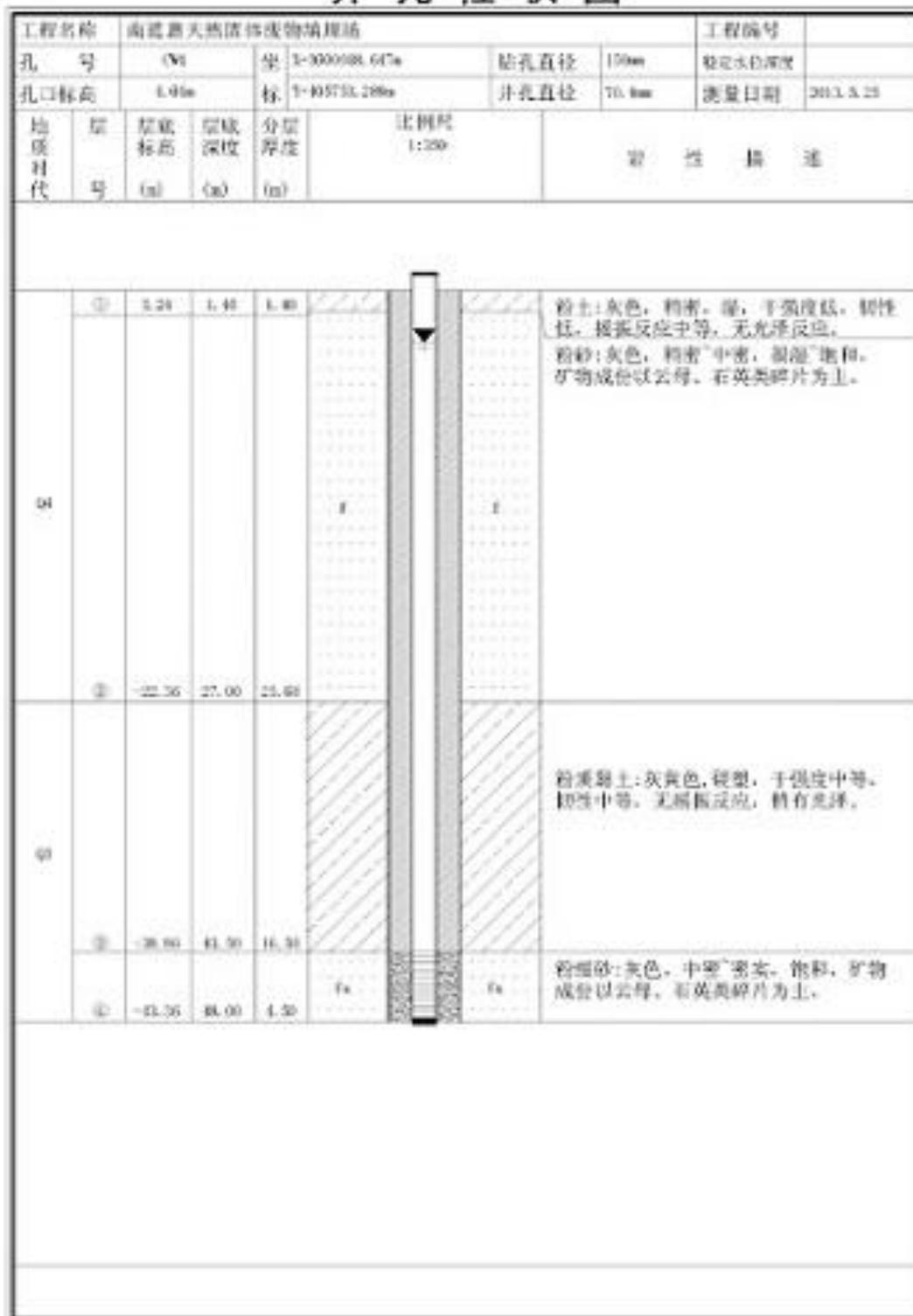
图 3.1-9 园区典型钻孔柱状图
