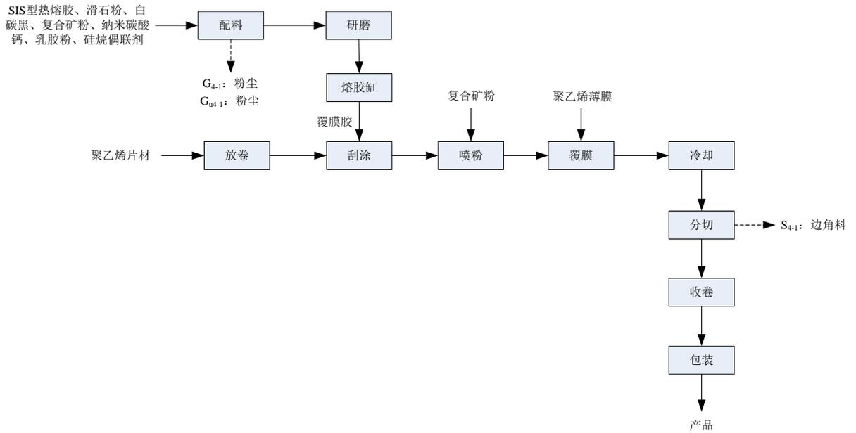
图 4.3-13 CRC 反应型防水卷材工艺流程及产污环节图
