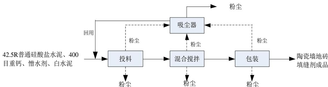
图 4.3-9 陶瓷墙地砖填缝剂工艺流程及产污环节图
