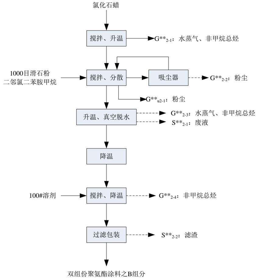
图 4.3-6 双组份聚氨酯防水涂料之 B 组分工艺流程及产污环节图
